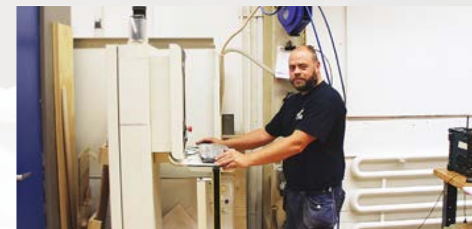
Peter Andersson programmerar en Morbidelli, en 5-axlig numeriskt styrd fräs. Denna maskin är så avändbar att företaget investerat i en till.
