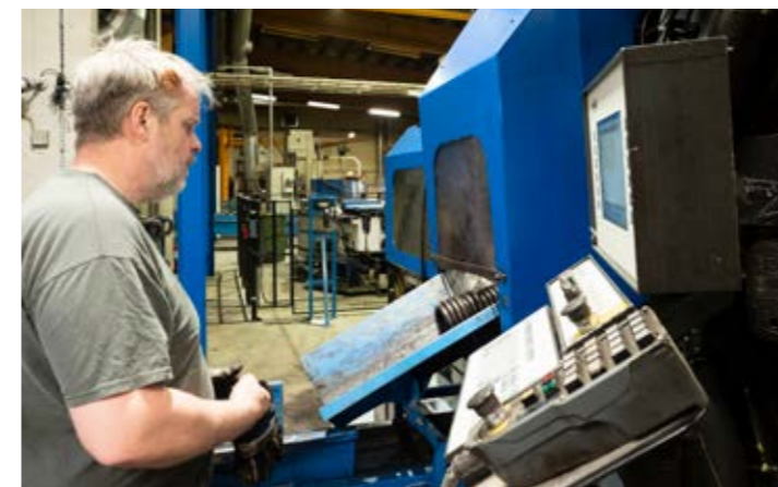
Jonas Stenberg, klubbordförande kör fjäderlindningsmaskinen. Här tillverkas fjädrar med en tråddiameter från åtta till 26 millimeter.
