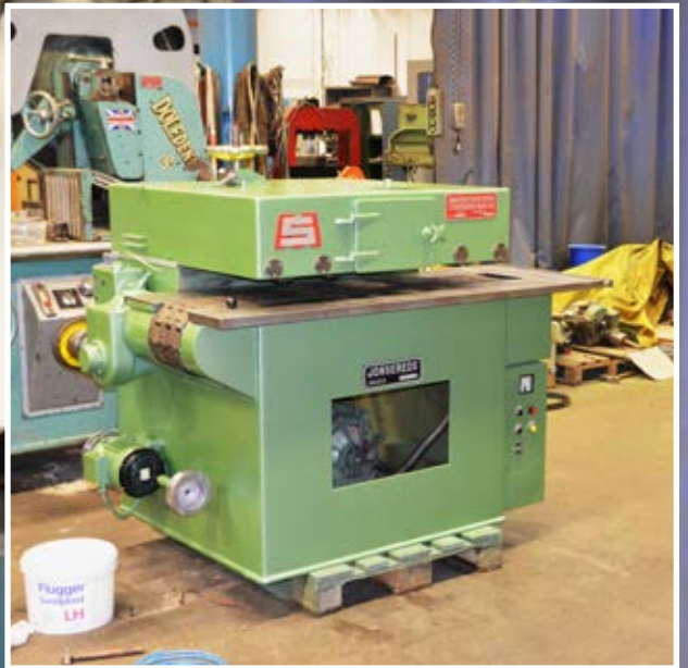
Lamellsåg som Anders byggt om och själv nyttillverkat det mesta av.
