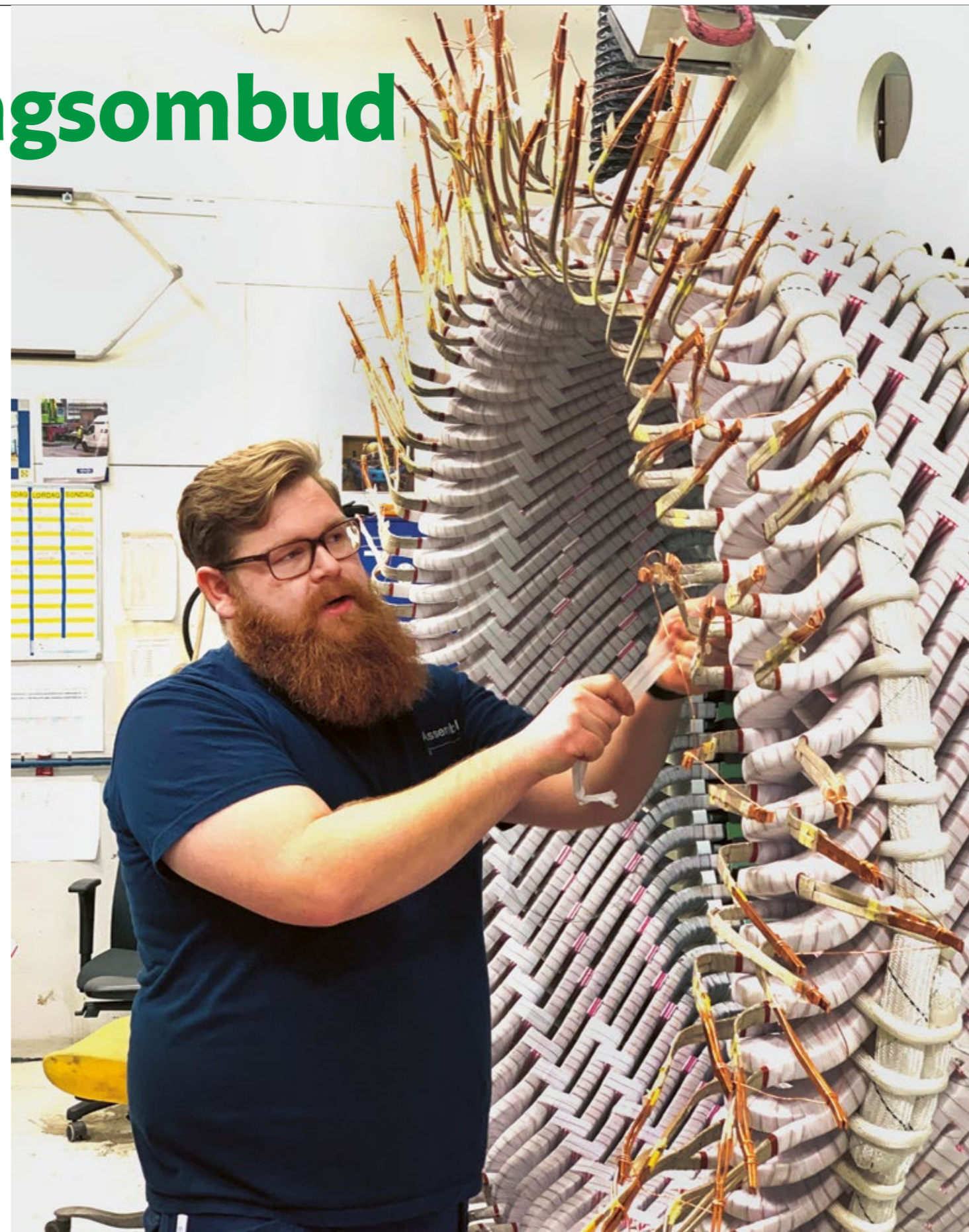
Kristoffer Söderström arbetar med att reparera en elmotor modell större.
