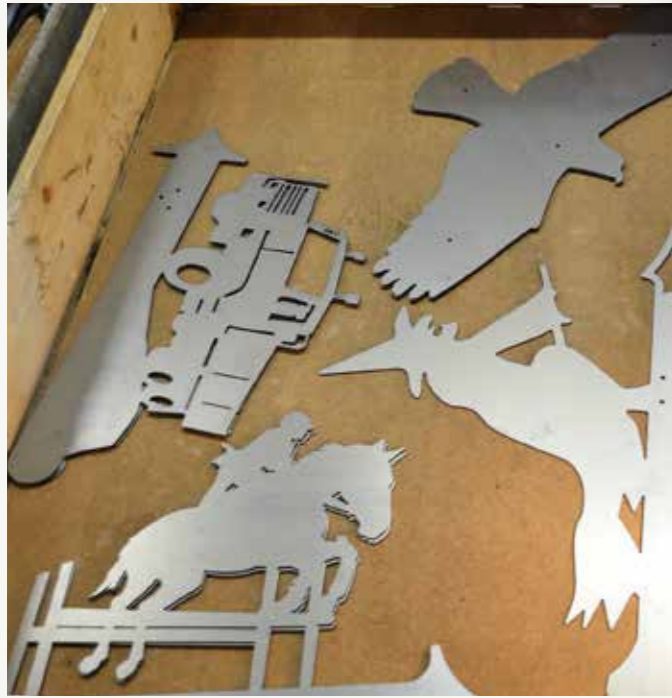
Laserutskurna silhuetter till vindflöjlar. Silhuetterna skärs ut hos underleverantörer efter färdiga CAD-ritningar.
