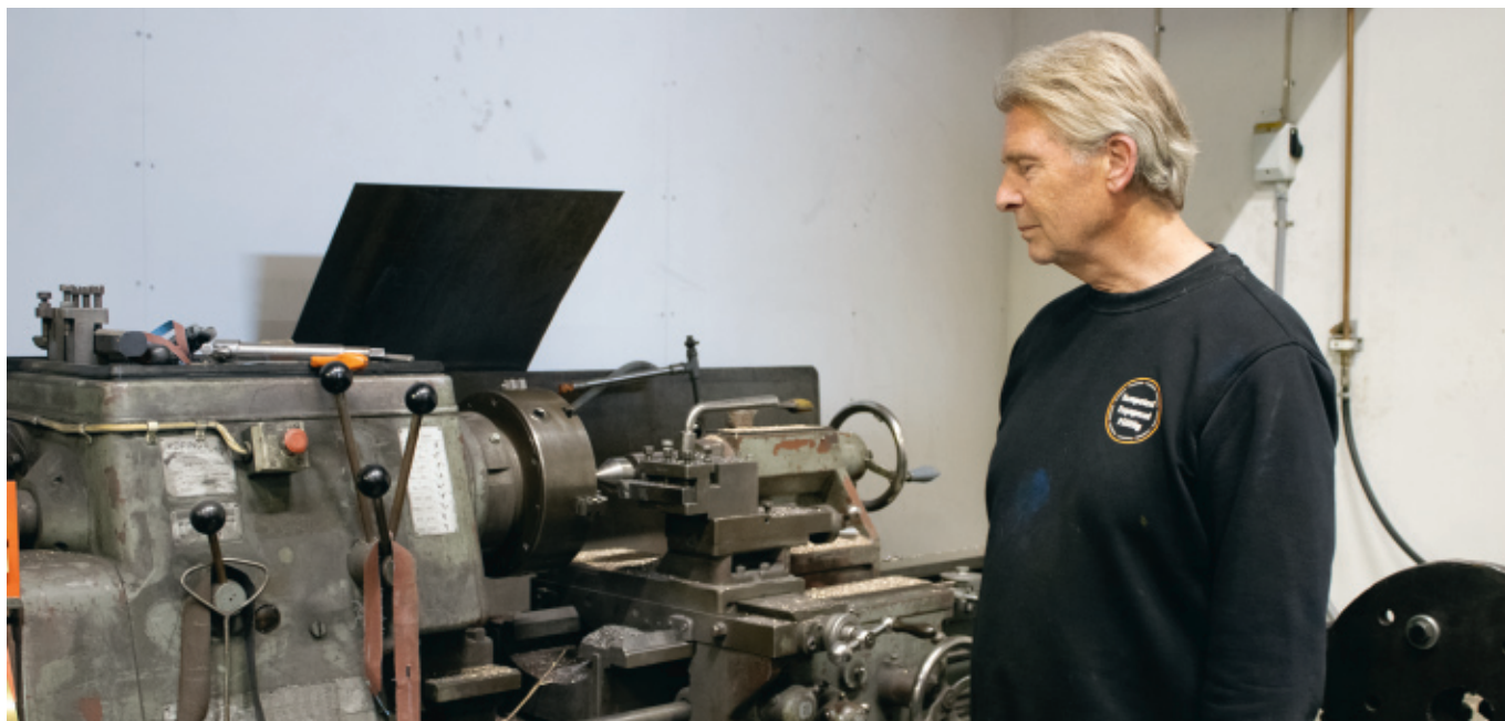
▲ Svarven från Köping har varit med på företaget sen 1950-talet. Här svarar Göran pumphjul ibland. Det är viktigt att man är noggrann för toleranserna är på en tiondels millimeter.
