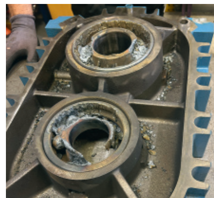
▲ En blåsmaskin som syresätter vattenbassänger på reningsverk. Här har lagren skurit när den har gått i 2 000 varv i minuten.
