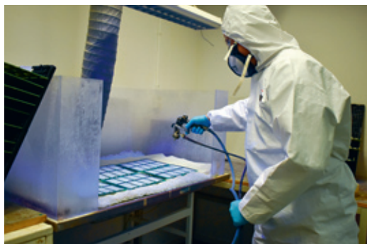
▲ Adrian Wladyslav Kupinski arbetar med lackering av kretskort. Ett arbete som kräver rätt utrustning och kompetens.
